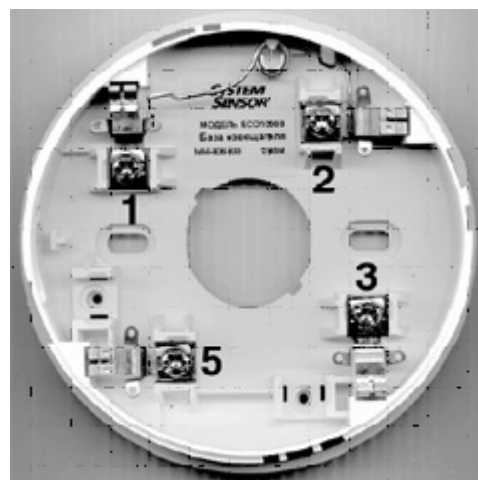
1 pav. Bazės E1000B kontaktų išdėstymas
